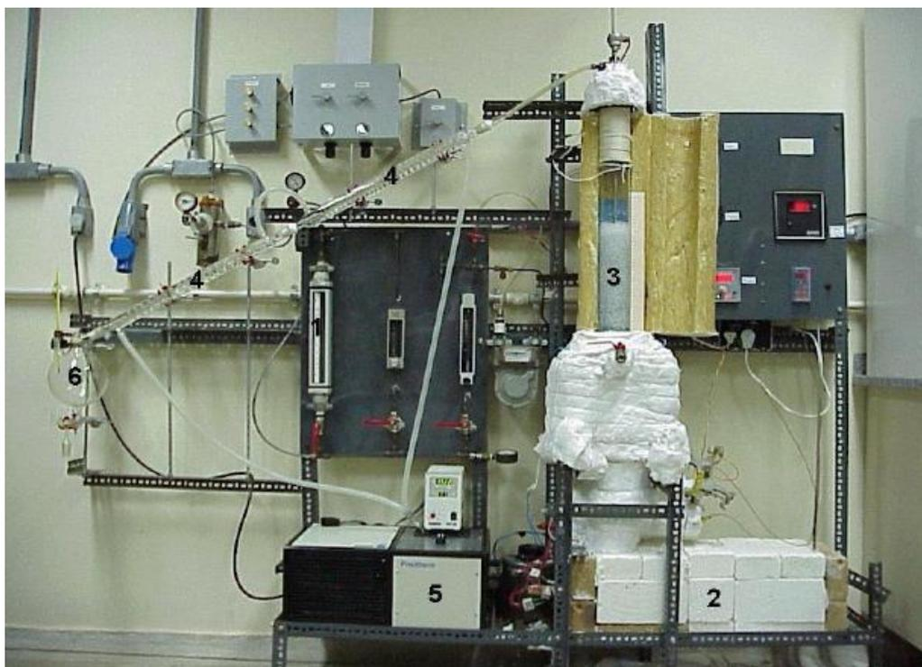
**Figura 3.6:** Fotografia do aparato experimental: (1) rotômetros, (2) forno, (3) coluna, (4) condensadores, (5) banho termostático e (6) coleta de condensado.
