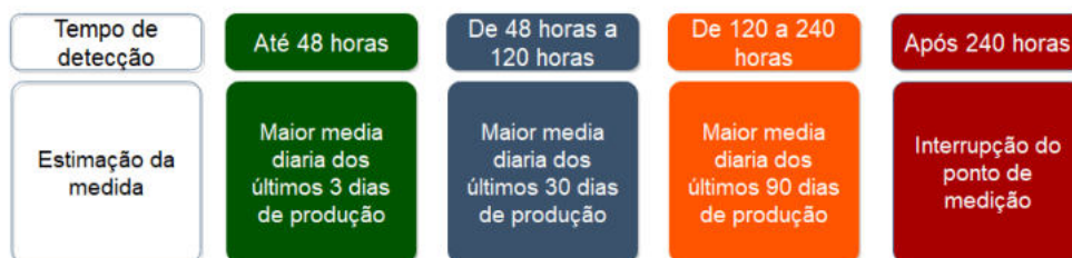
Figura 5.3: Metodologia de estimação de valores perdidos ou corruptos durante falha - ANP [70].
