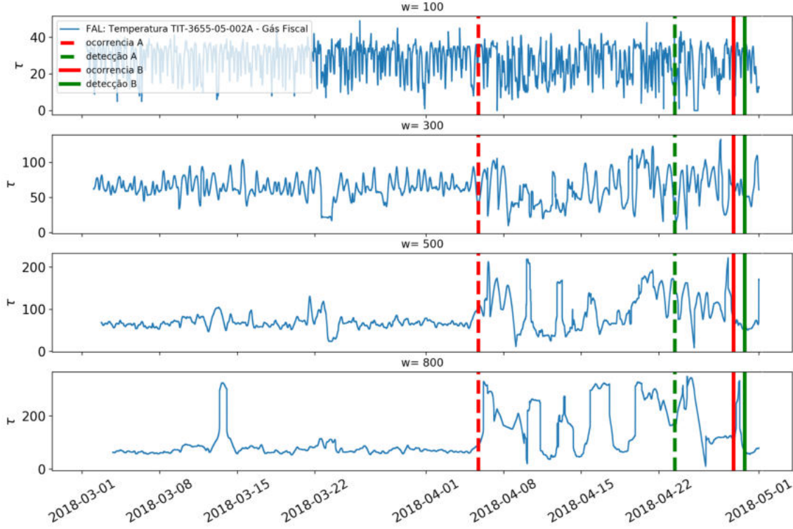
Figura 5.38: Sensibilidade do tamanho da janela w no comportamento do tempo de atraso \tau para obtenção de autocorrelação nula como função do tempo
