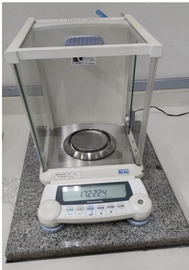
Figura 5.2 - Balança analítica.
