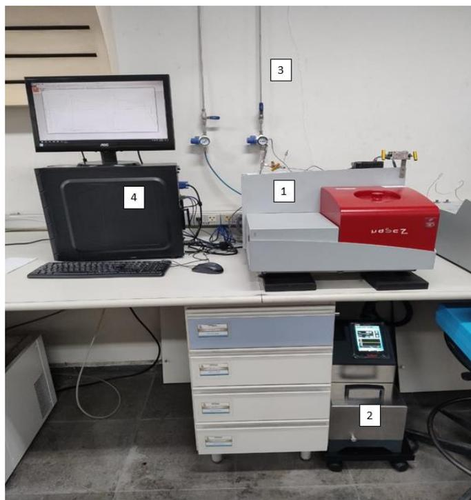
Figura 5.1 - Unidade experimental. (1) calorímetro; (2) banho termostático; (3) linha de nitrogênio ligada ao calorímetro; (4) computador conectado ao calorímetro.
