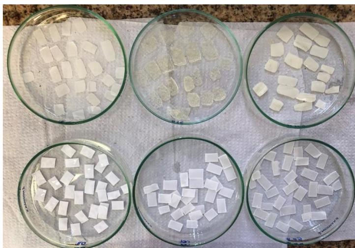
**Figura IV-2:** Corpos de prova dos homopolímeros e copolímeros sintetizados.
