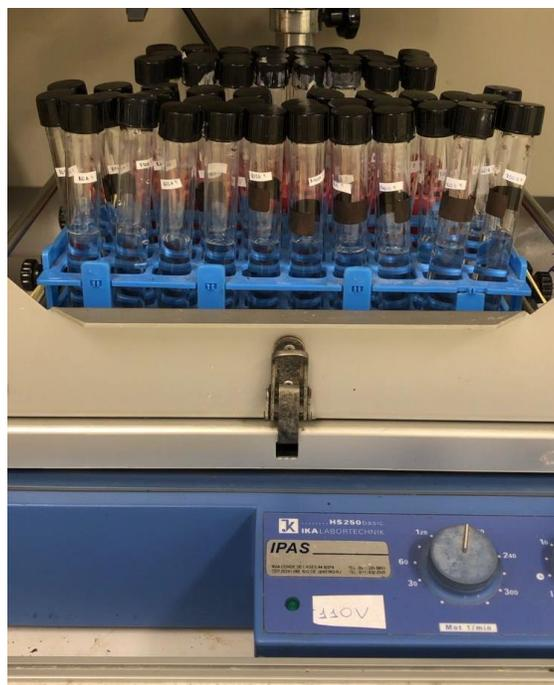
**Figura IV-3:** Unidade experimental usada para conduzir os testes de degradação.
