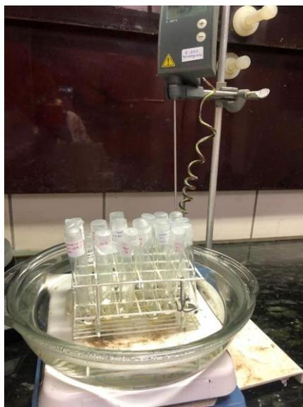
**Figura IV-1:** Unidade experimental usada para conduzir as reações de polimerização.
